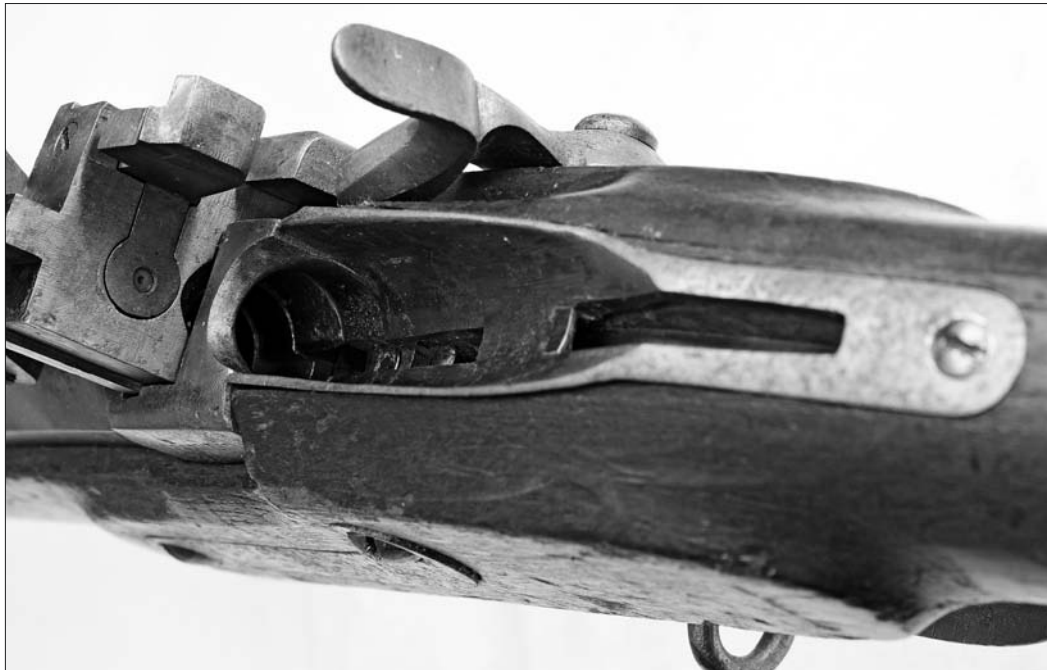
Pogled v notranjost odprtega zaklepa. Pozneje dodano, poenostavljeno uvodilo naboja je na dnu opremljeno s podolgovatim utorom, ki sega vse do ležišča naboja. Tu je bil verjetno nameščen preprost mehanizem za izvlek tulca (NMS, inv. št. N 36902, foto: Tomaž Lazar).
