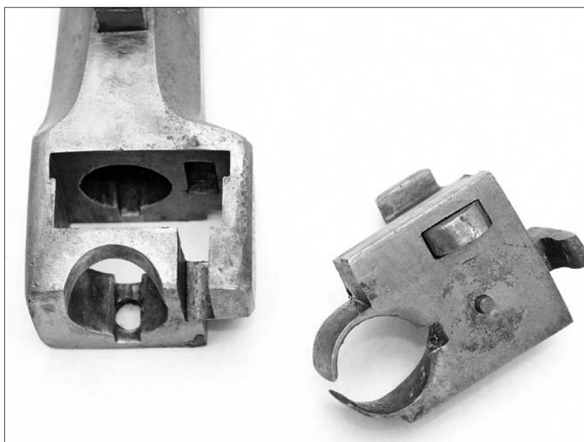
Poglavitni deli zaklepa: komora z ležiščem za naboj, vzvodna ročica in klinasti blok s »tolkačem« (NMS, inv. št. N 36902, foto: Tomaž Lazar).
