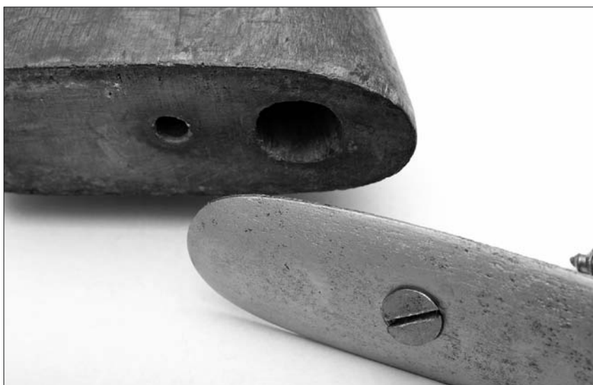
Odprtina za cevasti nabojnik v kopitu (NMS, inv. št. N 36902, foto: Tomaž Lazar).
