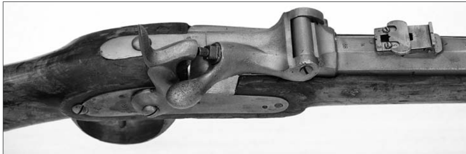
Lorenzova perkusijska risanica M 1862/67, predelana po sistemu Wänzel (NMS, inv. št. N 36948, foto: Tomaž Lazar).
