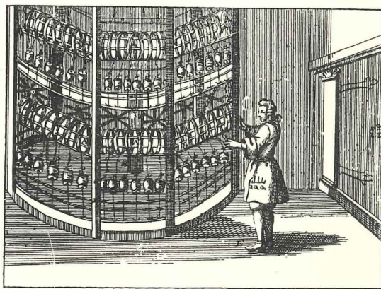
Slika 3. Veliki kolovrat (machina ali ital. filatorio)
