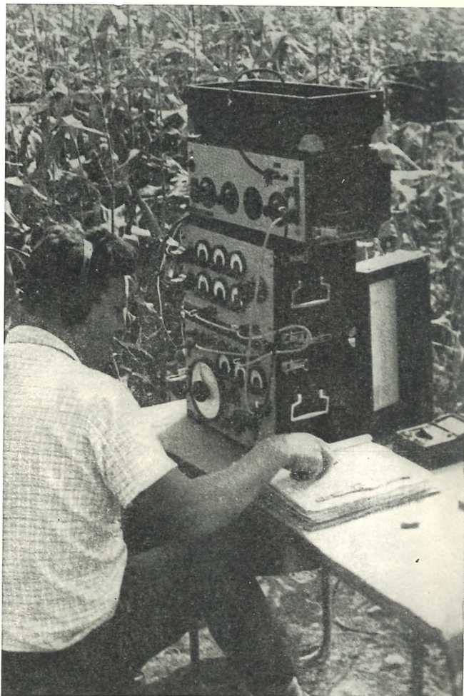
Sl. 1. Kapacitivna izravnava medkrajevnega kabla
