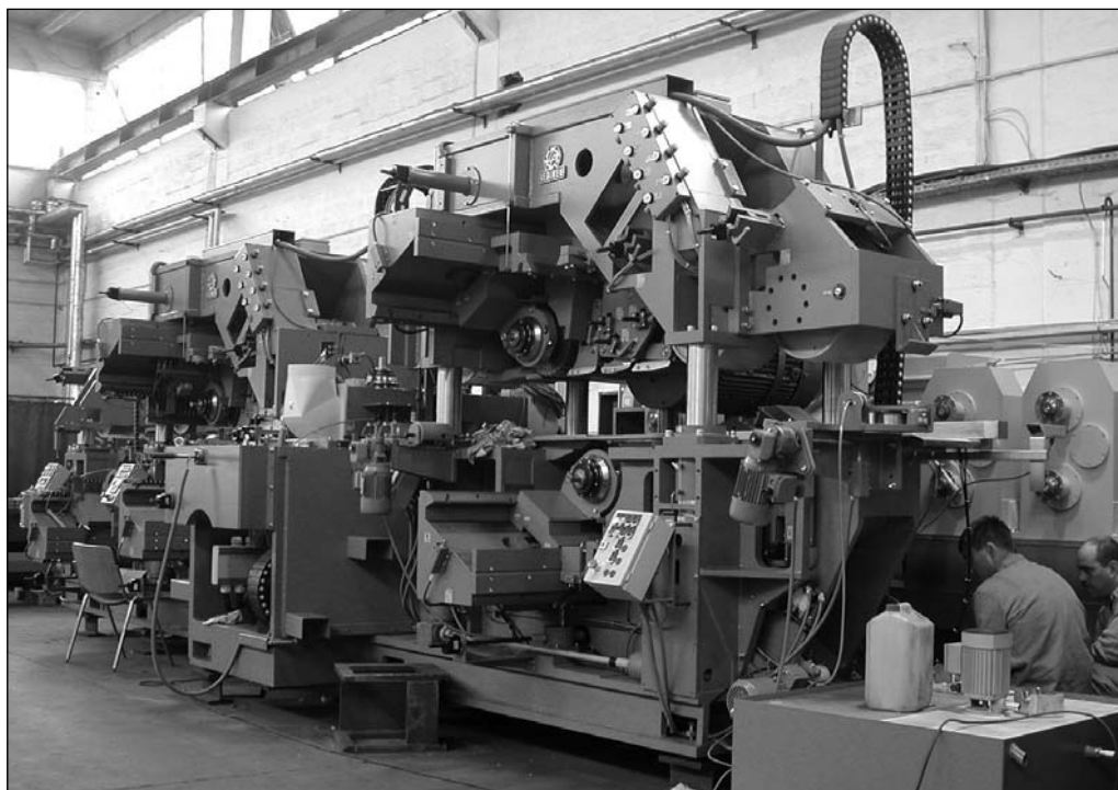
Slika 7: Najhitrejši skobeljni stroj Stratoplan, hitrost 750 m na minuto, masa 55 t
